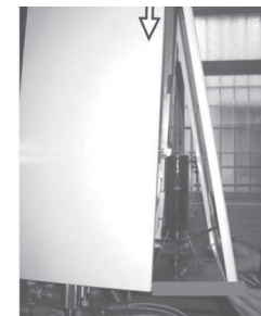
7. После выполнения проверки поставить крышку вертикально и установить ее
