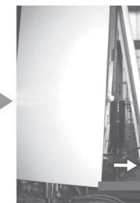
3. Взявшись за нижний край крышки, слегка потянуть вперед, и поднять ее.
